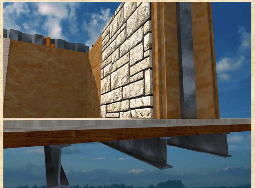
Il solaio, esclusa la struttura portante, avrà così uno spessore di 25 cm più le tegole, con una trasmittanza = 0,224 W/mqK ed uno sfasamento vicino oltre le 10 ore (cfr. la relazione tecnica di cui al D.lgs 192/2005 e ss. mm. ii. per il dettaglio di tutti i dati).
