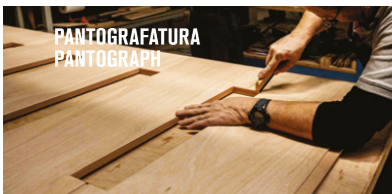
LEVIGATURA MANUALE MANUAL SANDING
