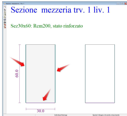
Rappresentazione rinforzo con placcaggi in m. composito
