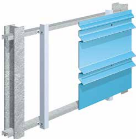
Sottostruttura in sistema a montanti e traversi
