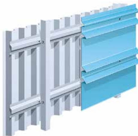
Sottostruttura in profilati trapezoidali
