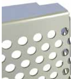
RV 6-8 Percentuale di fori: min. 44 %, max 48 % in funzione della larghezza del pannello Diametro dei fori: 6 mm
