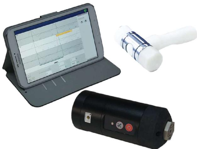
P8000 di Novatest, usando il metodo di onda riflessa, viene utilizzato per valutare l'integrità del palo in cemento e individuare l'entità e la posizione del difetto. Può essere utilizzato per testare sia pali infissi che gettati in opera ed è impiegato anche per testare la superficie superiore esposta.
