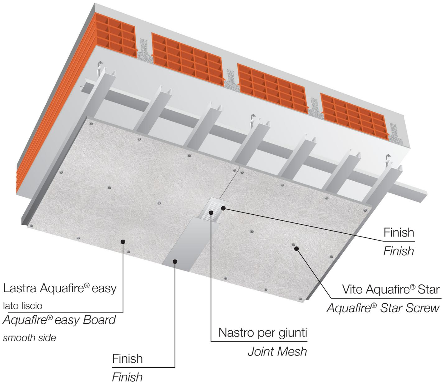
Le lastre **Aquafire® easy** hanno una doppia possibilità di applicazione in funzione del tipo di finitura che si deve ottenere: **superficie liscia** oppure **superficie rivestita** con intonachino o rivestimento incollato.
