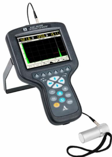
A1221 ANCHOR è uno strumento ad ultrasuoni per la valutazione in situ di elementi metallici incorporati mediante onde ultrasoniche a bassa frequenza.
