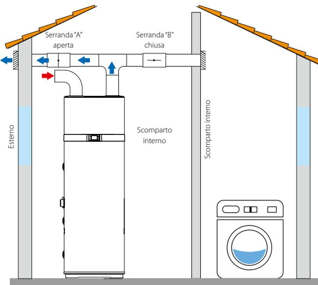
**Fig. 4** - Esempio di installazione in inverno
