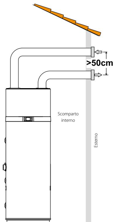
**Fig. 2** - Esempio di collegamento di ingresso e mandata dell'aria
