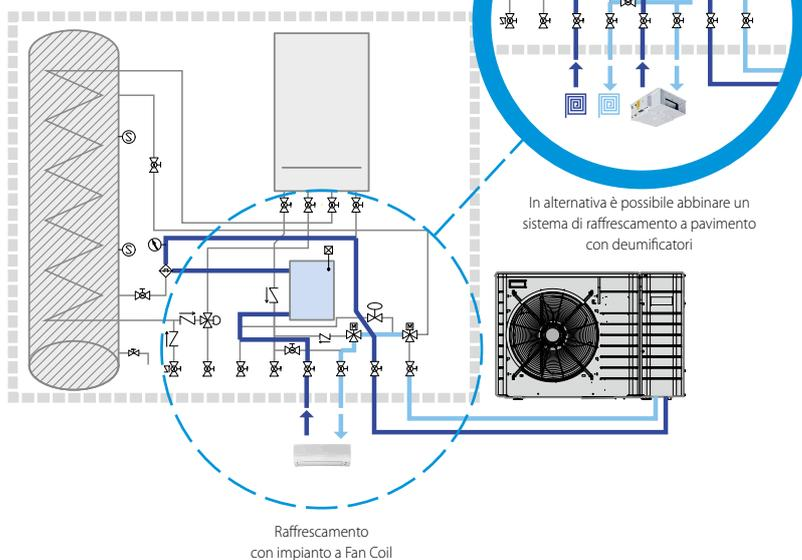
In alternativa è possibile abbinare un sistema di raffrescamento a pavimento con deumidificatori
