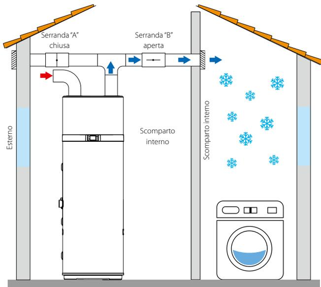
**Fig. 3** - Esempio di installazione in estate
