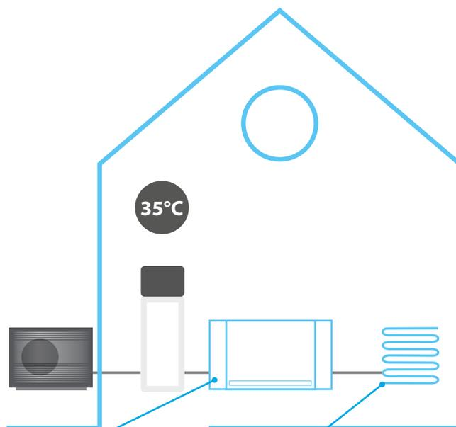
Il **sistema radiante** è progettato per ricevere acqua a media temperatura per il riscaldamento della casa, ma quando arriva l'estate, le tubazioni possono essere utilizzate anche per convogliare acqua fredda per raffrescare l'ambiente.
