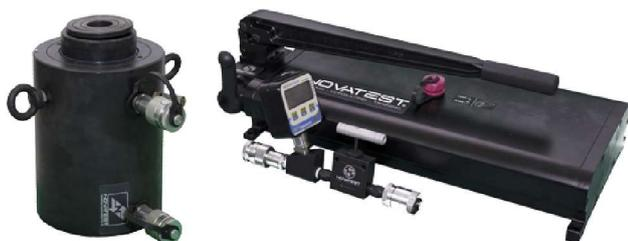
Le prove di carico statiche sono eseguite per valutare gli abbassamenti verticali del palo per effetto del carico di prova.
