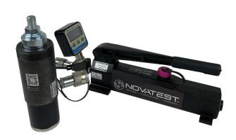
Prova di estrazione di un ancorante metallico per la stima della resistenza in sito del calcestruzzo. La prova di estrazione denominata Pull-Out viene classificata tra i metodi di indagine semi-distruttivi.
