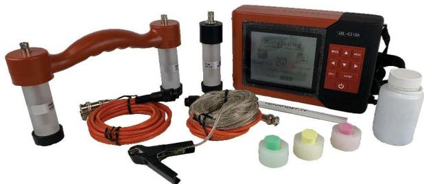
La corrosione dell'acciaio all'interno del calcestruzzo riduce l'area effettiva della sezione della barra d'acciaio e porta ad un aumento di volume. Tale espansione comporta una demolizione dell'elemento in calcestruzzo, riducendo le caratteristiche meccaniche e di durabilità del materiale, e di conseguenza la sicurezza delle strutture coinvolte.
