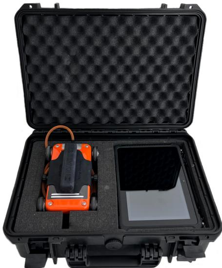
Il VIY®5-1500 GPR è adatto per l'ispezione di strutture in calcestruzzo o muratura e per la ricerca di oggetti sia metallici che dielettrici (localizzazione di crepe, vuoti, armature, ecc.).
