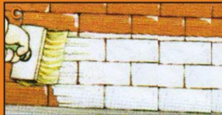
**B)** In seguito si procede al lavaggio della muratura con acqua, eventualmente con detergente acido diluito e poi risciacquare abbondantemente con sola acqua.
