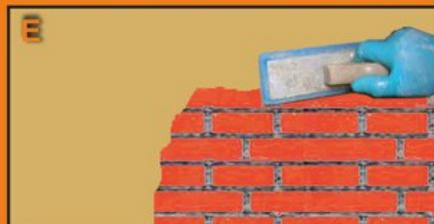
**E)** Preparare l'intonaco deumidificante solo con l'additivo SP 600 nelle dosi consigliate, n°1 sacchetto predosato con kg. 50 di legante calce/cemento, sabbia ed acqua, impastando per almeno 15 minuti, procedendo alla formazione delle guide e successivamente alla realizzazione dell'intonaco con spessore di almeno cm 2. Applicare il velo di calce finale e finire a civile con fratazzo di spugna. Si consiglia di bagnare l'intonaco per i primi giorni.
