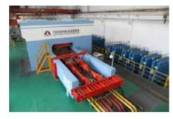
Figura 7 Macchina di test dei dispositivi sismici di proprietà HIRUN, Wuhan (Cina).
