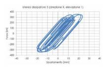
Figura 5. Esempio di un ciclo isteretico di un dissipatore VSD derivante dalle analisi non lineari
