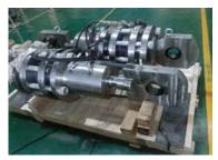
Figura 4. Dissipatore HIFLUID VSD
