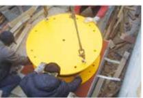
**DISSIPATORI FLUODINAMICI** HIFLUID VDD-VSD: hanno la funzione principale di dissipare energia indotta dal sisma, ridurre le vibrazioni e gli effetti del vento o di altre azioni dinamiche. Sono disponibili i dissipatori viscosi con capacità di ricentraggio. Principali impieghi: edifici e strutture civili ed industriali in aree sismiche, ponti stradali e ferroviari. Conformi alla EN 15129 Cap. 7. I materiali sono conformi alla EN 10025 e EN 10088.
