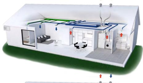
COMPACT con integrazione di unità di climatizzazione SPLIT ad espansione diretta canalizzata nella distribuzione della VMC
