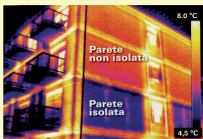
L'efficienza energetica di un edificio è in funzione dell'isolamento termico delle murature esterne, ed è tanto più efficiente quanto maggiore è il coefficiente termico e la resistenza "R" delle murature. Quindi maggiore è l'isolamento della muratura, minore è la dispersione termica a vantaggio del risparmio energetico e del comfort percepito dagli abitanti.
