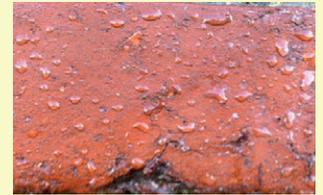
E' sufficiente l'applicazione di una sola mano di Barridry per impedire l'assorbimento di acqua nei materiali porosi come con mattoni in cotto, pietre arenarie, cemento e malte. Inoltre data la natura del composto a base Silano Silossano, penetrando in profondità mantiene inalterata la traspirabilità del materiale lasciandolo "respirare" attivamente.
