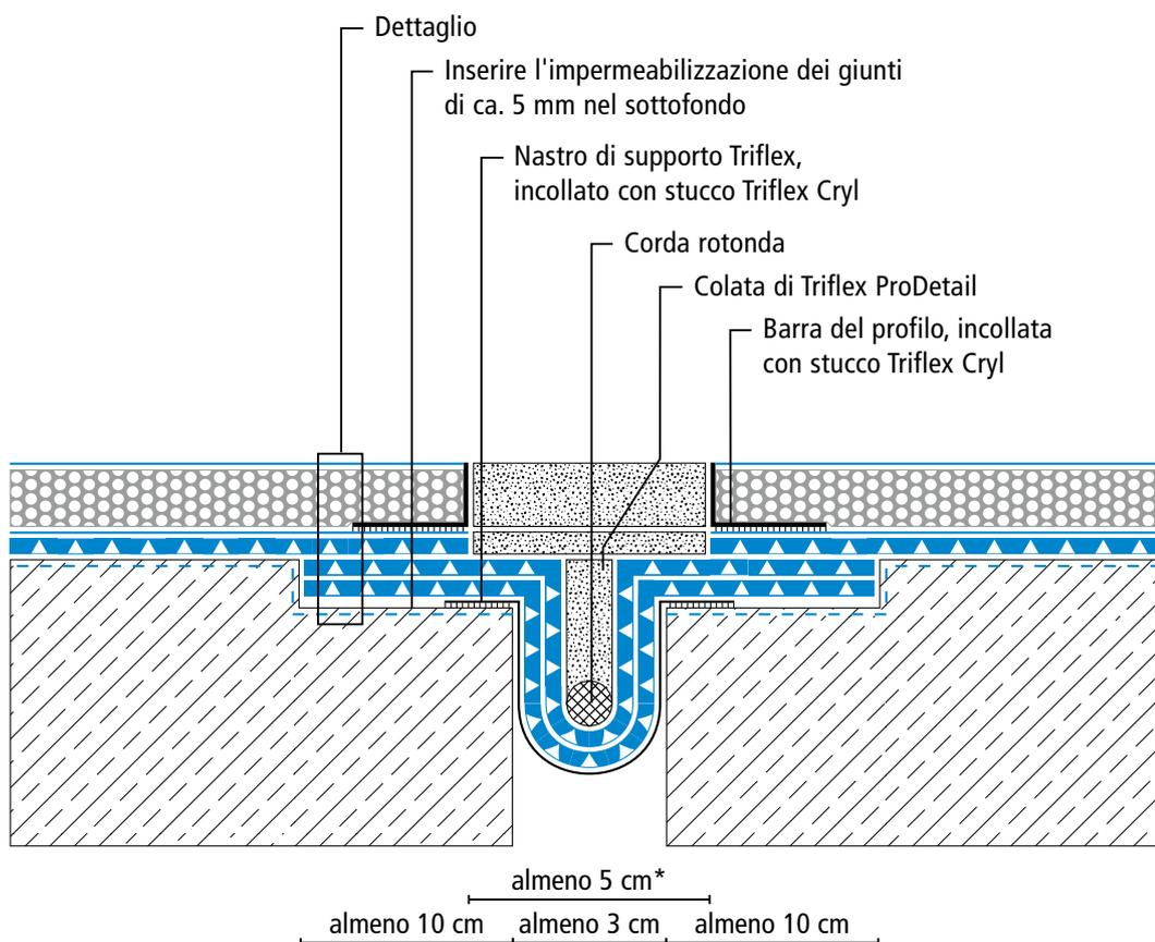
\* Spazio libero da impermeabilizzazione della superficie e sigillatura (ved. Descrizione del sistema)
