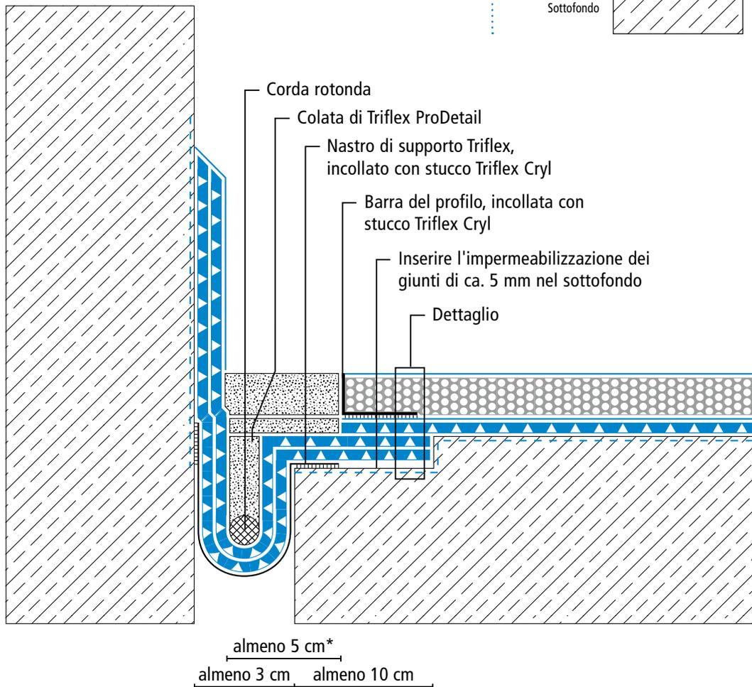
\* Spazio libero da impermeabilizzazione della superficie e sigillatura (ved. Descrizione del sistema)
