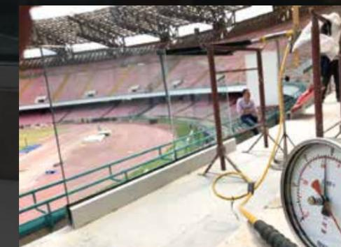
**PROVE DI LABORATORIO FINO A 1000 KG. SENZA ALCUNA ROTTURA CON VETRO 12+12+1,52 SG (SENTRY GLAS).**
