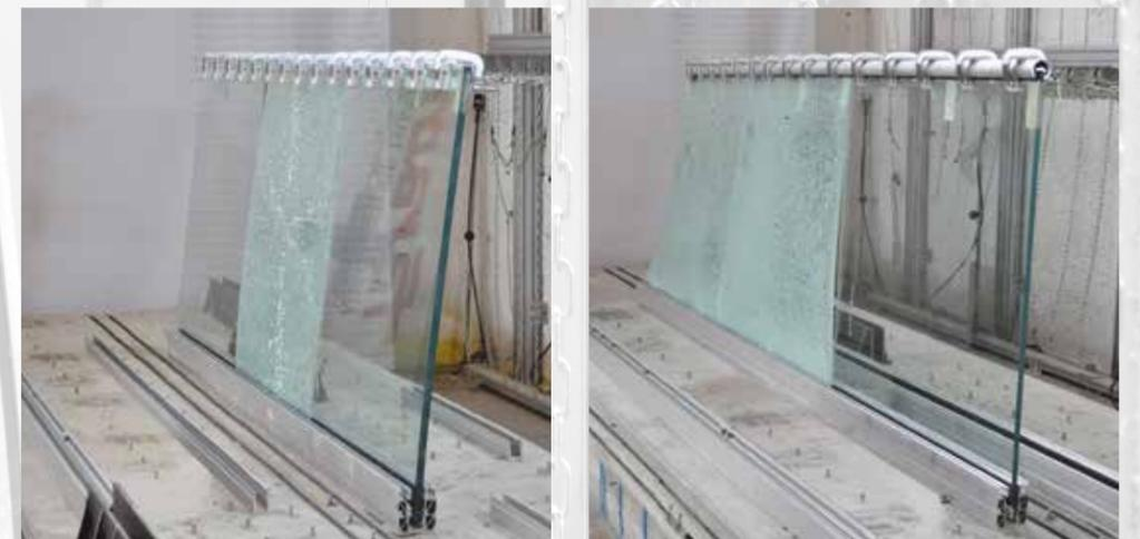
**Il profilo NINFA STADIO, oltre a rispettare la NUOVA NORMA CNR, rispetta l'ulteriore norma UNI EN 13200-3-2006 indicata per garantire la sicurezza in strutture pubbliche come stadi, tribune, discoteche, ecc. Classe 500 Kg/m + 50% di tolleranza per un totale di 750 Kg/m.**
