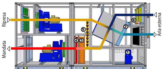
Il funzionamento prevede che l'aria esterna deumidifichi l'ambiente compensando l'evaporazione della vasca. Il circuito frigorifero (costituito dal compressore 1 e dalle batterie 2 e 3) consente di recuperare il calore sia sensibile sia latente dall'aria espulsa e trasferirlo all'aria immessa oppure all'acqua attraverso il sistema di scambio termico costituito dal doppio scambiatore sul lato acqua.
