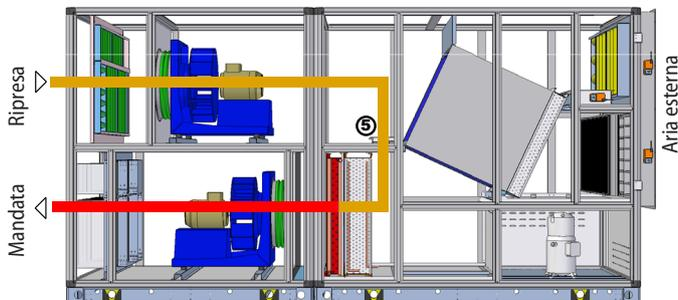
Il funzionamento prevede che la portata d'aria esterna sia pari a zero. L'intera portata d'aria viene ricircolata attraverso la serranda 5 e reimessa nel locale piscina.
