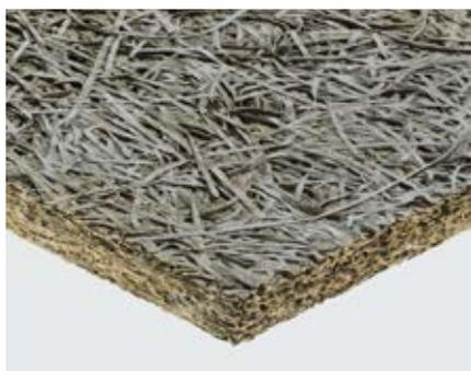
Pannello isolante termico ed acustico, specifico per applicazione a cappotto, in lana di legno di abete rosso mineralizzata e legata con cemento Portland grigio. Larghezza lana di legno: 3 mm. Conforme alla norma UNI EN 13168. Certificato da ANAB-ICEA e natureplus per la ecocompatibilità dei materiali e del processo produttivo. CELENIT N/C è certificato PEFC™. Disponibile anche con certificazione FSC®.
