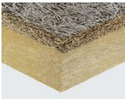
Pannello isolante termico ed acustico composito, costituito da uno strato in lana di legno di abete rosso mineralizzata e legata con cemento Portland grigio, spessore 50 mm, accoppiato ad uno strato di lana di roccia conforme alla norma UNI EN 13162. Conforme alla norma UNI EN 13168. CELENIT L2 è certificato PEFC™. Disponibile anche con certificazione FSC®.
