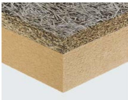
Pannello isolante termico ed acustico composito, costituito da uno strato in lana di legno di abete rosso mineralizzata e legata con cemento Portland grigio, spessore 50 mm, accoppiato ad uno strato di fibre di legno conforme alla norma UNI EN 13171.
