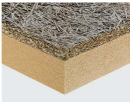
Pannello isolante termico ed acustico composito, specifico per l'applicazione a cappotto, costituito da uno strato in lana di legno di abete rosso mineralizzata e legata con cemento Portland grigio, spessore 25 mm, accoppiato ad uno strato di fibre di legno conforme alla norma UNI EN 13171.
