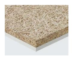
Pannello isolante termico acustico composito, antincendio certificato El 60, costituito da uno strato in lana di legno sottile di abete rosso mineralizzata e legata con cemento Portland bianco, conforme alla norma UNI EN 13168, spessore 25 mm, accoppiato ad una lastra in cartongesso tipo F, conforme alla norma UNI EN 520, spessore 15 mm. Larghezza lana di legno: 2 mm. Pannelli di alta qualità per sistemi di design e assorbimento acustico.
