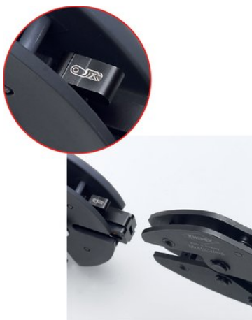
Marcatura ben visibile delle matrici di crimpaggio con pittogrammi
