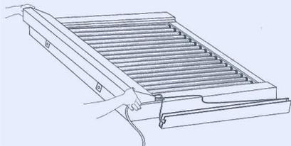
2) Fissare tramite rivetti o viti le cerniere posteriori del cassonetto sul collettore.
