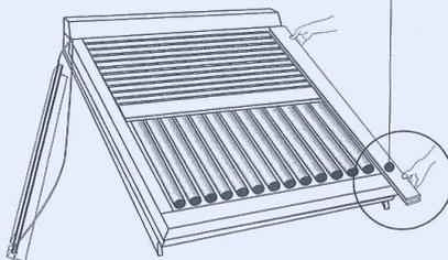
4) Fissare la guida con la vite tolta in precedenza.
