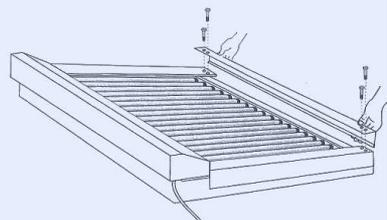
È possibile forare su tutta la lunghezza delle guide, l'aletta di rinforzo sottostante. (Per modelli standard la foratura è già presente per facilitare il fissaggio).
