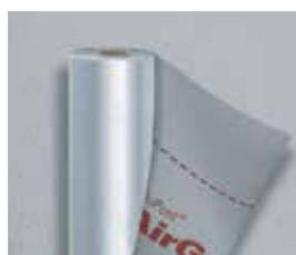
Barriera al vapore metallizzata (**s<sub>d</sub> 2000 m**), 149 gr/m<sup>2</sup>, per il controllo del vapore con superficie a bassa emissività che incrementa l'isolamento termico degli edifici.
