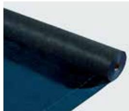
Freno al vapore (**s<sub>d</sub> 25 m**), 145 gr/m<sup>2</sup>, con elevata resistenza meccanica, da posizionare sul tavolato, sotto l'isolante. A tenuta d'aria, evita danni da condensa. Resistente ai raggi UV.
