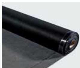
Membrana impermeabile ad elevata traspirazione ( $s_d$  **0,04 m**), con banda butilica laterale, ad alta grammatura, 205 gr/m<sup>2</sup>, sviluppata per tetti ad elevata pendenza. Resistente ai raggi UV.
