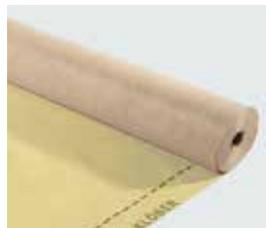
Freno al vapore (**s<sub>d</sub> 3 m**), 160 gr/m<sup>2</sup>, con elevata resistenza meccanica, da posizionare sul tavolato, sotto l'isolante. A tenuta d'aria, evita danni da condensa. Resistente ai raggi UV.
