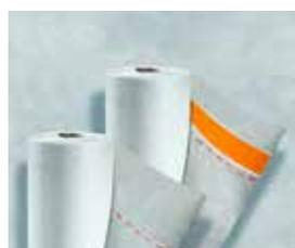
Membrana permeabile al vapore ( $s_d$  **0,03 m**), 148 gr/m<sup>2</sup>, per coperture inclinate ventilate. Aiuta a ridurre il rischio di formazione di condensa e a diminuire le infiltrazioni d'aria.
