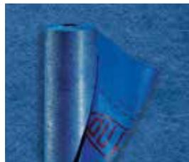
Freno al vapore (**s<sub>d</sub> 5 m**), 108 gr/m<sup>2</sup>, con elevata resistenza meccanica, da posizionare nella parte calda dell'isolamento. A tenuta d'aria, evita danni da condensa.
