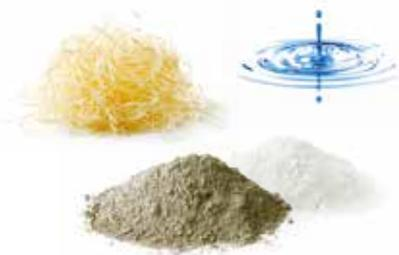
Le fibre vengono sottoposte ad un trattamento mineralizzante che, pur mantenendo inalterate le proprietà meccaniche del legno, ne annulla i processi di deterioramento biologico, rendendole inerti e aumentandone la resistenza al fuoco. Vengono rivestite con cemento Portland, legate assieme sotto pressione a formare una **struttura stabile, resistente, compatta e duratura**.
