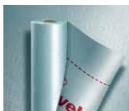
Membrana permeabile al vapore ( $s_d$  **0,02 m**), 148 gr/m<sup>2</sup>, per coperture inclinate ventilate, con superficie metallizzata esterna che incrementa l'isolamento termico invernale ed estivo.
