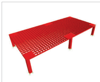
Modellazione shell+solid struttura indeformata.
