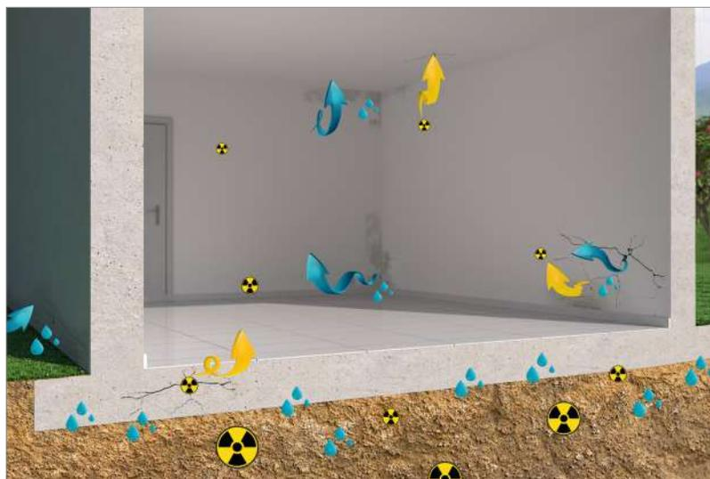
Pericolo del gas Radon e dell'umidità di risalita all'interno di un'abitazione costruita con una fondazione tradizionale.
