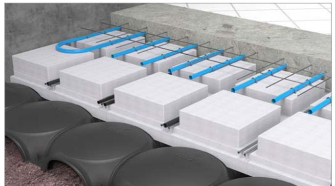
**4** Posa delle armature della soletta di completamento e delle armature all'interno delle nervature. Successivamente, procedere al getto del calcestruzzo della soletta nervata che dovrà essere ben "battuto" (specie ai lati e negli angoli), costipato in tutto il suo spessore, stagiato e frattazzato (a mano o con elicottero) a regola d'arte. Dopo aver atteso la stagionatura del cls è possibile procedere con la posa della pavimentazione, secondo progetto.
