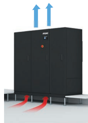
Esecuzione con aspirazione dal basso con sottobase per pavimento sopraelevato, pannello frontale cieco e mandata dell'aria verso l'alto.
