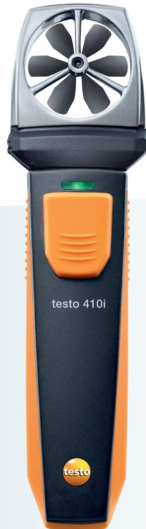
L'anemometro a elica Bluetooth testo 410i, in combinazione con uno smartphone o un tablet, è adatto per misurare la velocità d'aria, la portata e la temperatura sulle bocchette dell'aria e per regolare il flusso d'aria di un impianto di ventilazione. Tramite la app installata sul dispositivo mobile, gli utenti possono leggere comodamente i valori misurati, configurare in modo rapido e semplice le misure della portata e determinare con
