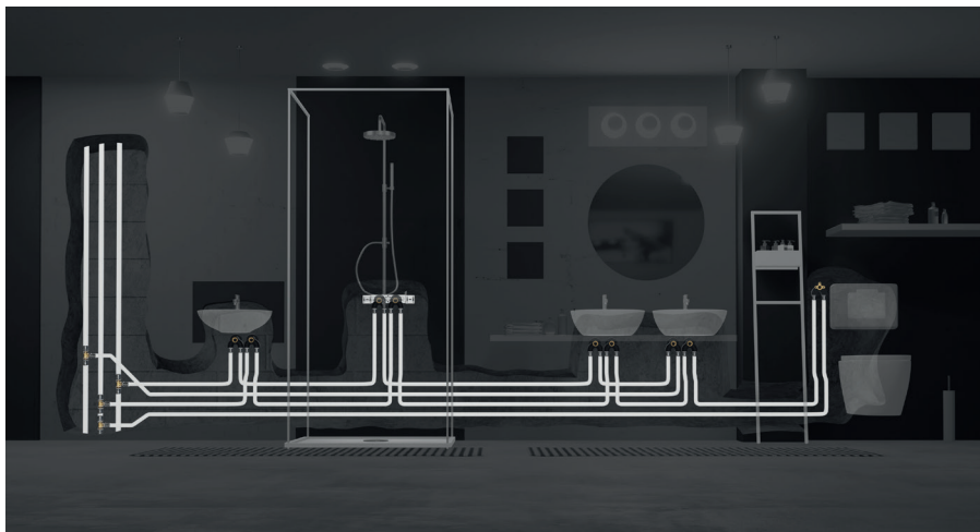
Fig. 41: Installazione ad anello con linea di ricircolo.
