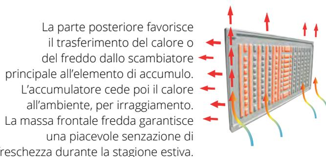
La parte posteriore favorisce il trasferimento del calore o del freddo dallo scambiatore principale all'elemento di accumulo. L'accumulatore cede poi il calore all'ambiente, per irraggiamento. La massa frontale fredda garantisce una piacevole sensazione di freschezza durante la stagione estiva.
