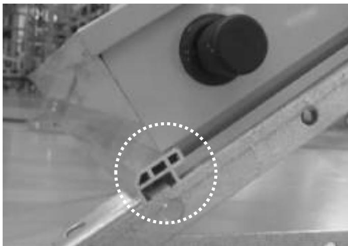
3.2. Introducir el colector solar en la barra de fijación colector superior (9) desplazándola hacia arriba.
