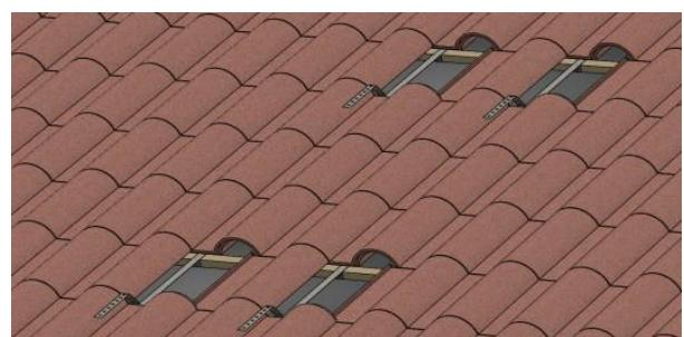
2.9. Fijar la estructura a los 4 flejes de acero perforados (7), utilizando 4 bulones, 4 tuercas y 4 arandelas.
