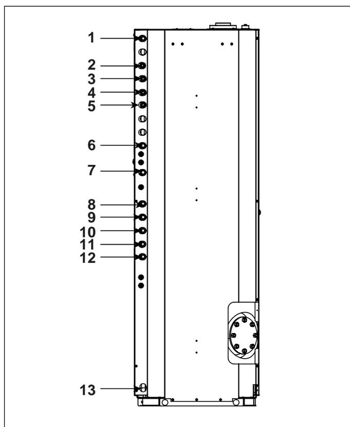
Fig. 6 Collegamenti idraulici KRBS V - KRBS MV
