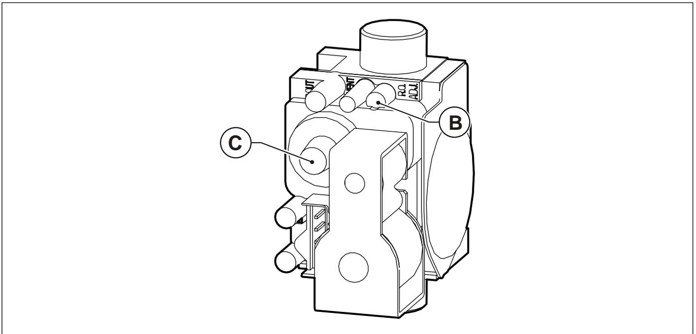
Fig. 44 Regolazione valore anidride carbonica
