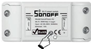
Ora il relè è pronto per essere abbinato al Gateway, quando si arriva ai punti 4 e 6 del capitolo precedente *Abbinamento con una seconda o terza Espansione di zona sullo stesso Gateway*, fare un click veloce sul pulsante del relè in modo da abbinare il relè al proprio Spot termostato.
