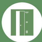
I montanti verticali, la traversa superiore e il montante di battuta sono preintonacati o da stuccare, permettendo di integrare totalmente il telaio, con un risultato di assoluta omogeneità della parete, mentre con la tecnologia Luce di ECLISSE si possono applicare fino a 10 scatole elettriche per anta (5 da un lato e 5 dall'altro).
