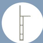
L'installazione si esegue predisponendo l'incavo per il battiscopa e collocando degli appositi profili in alluminio forato in fase di costruzione della muratura, prima di eseguire l'intonacatura e la posa del pavimento. **ECLISSE SYNTESIS® BATTISCOPIA** realizza la perfetta combinazione armonica attraverso l'abbinamento con i modelli scorrevoli e battenti di **ECLISSE SYNTESIS® COLLECTION**.
