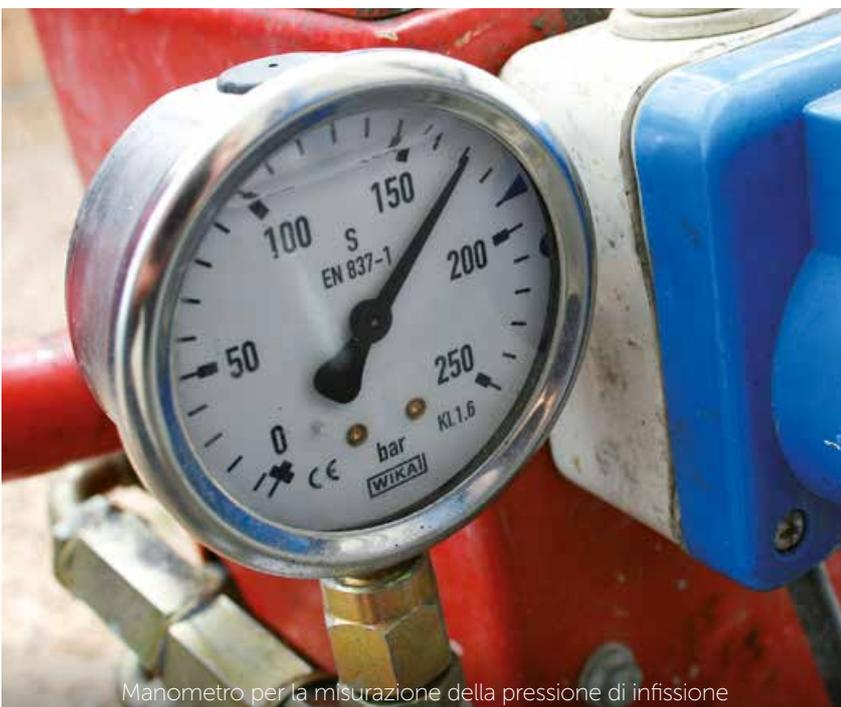
Manometro per la misurazione della pressione di infissione
