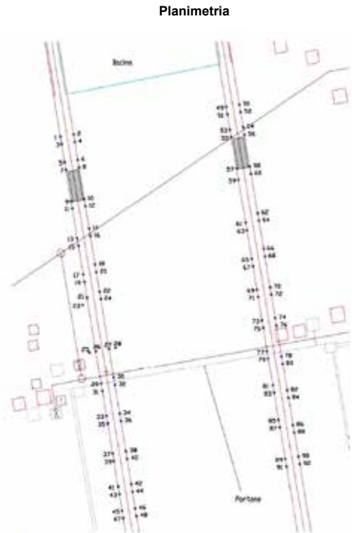
n. 92 micropali 60x8 a presso infissione MP/60 in acciaio rollato Fe510
