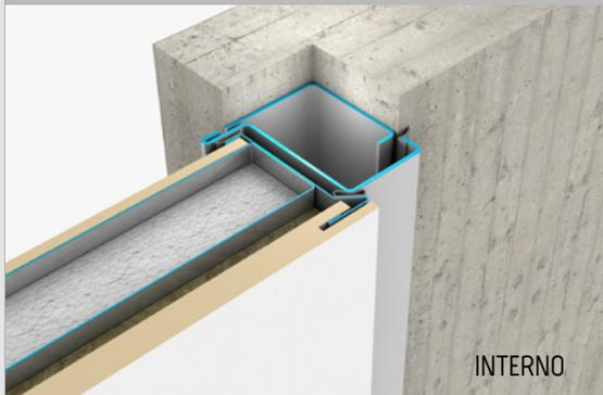
1 Soluzione standard senza profili di copertura telaio (Controtelaio posa standard)
