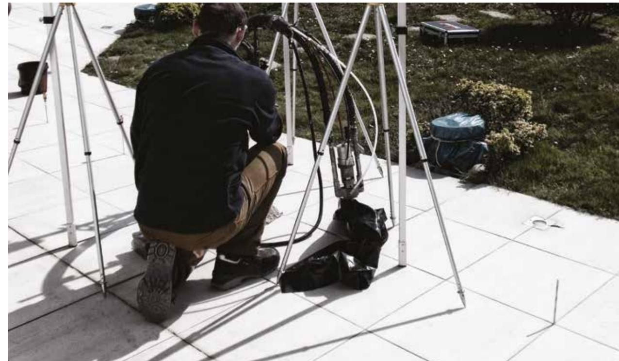
Grazie ad un controllo laser puntuale i nostri tecnici potranno identificare e mappare le zone di maggior depressione della pavimentazione ceduta così da rilevarne l'estensione e i
