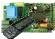
**TEL\*** Sistema per gestione con telecomando. Scheda madre+Sonda aria+Sonda acqua+Ricevitore i.r.+Telecomando (gestione 2/4 tubi, con/senza valvole). **Ventilatore 7A-230Vac. Valvole: 2A-230Vac.** Remote control management system. Motherboard + Air sensor + Water sensor - I.R. receiver + I.R. Remote control (control 2-4 pipe units, with/without valves). **Fan 7A-230Vac. Valves: 2A-230Vac.**
