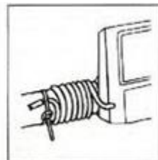
Avvolgere accuratamente i cavi intorno al tubo da una parte e dall'altra
