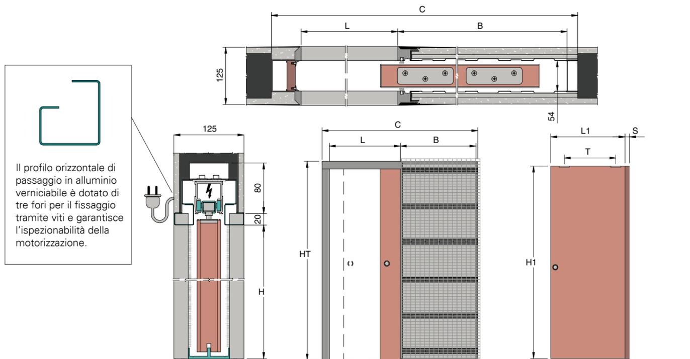
Il profilo orizzontale di passaggio in alluminio verniciabile è dotato di tre fori per il fissaggio tramite viti e garantisce l'ispezionabilità della motorizzazione.
