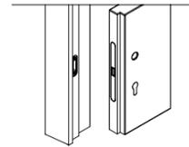
Serratura magnetica con foro cilindro
