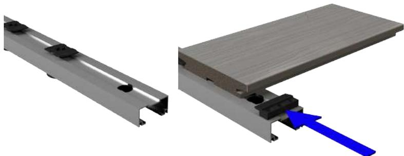
2) Posare una doga, spingerla verso la clip easychange e posizionare una clip partenza fine addossandola alla fresatura lasciando un minimo spazio di tolleranza. In questa maniera si ha la misura esatta per posizionare la clip partenza/fine
