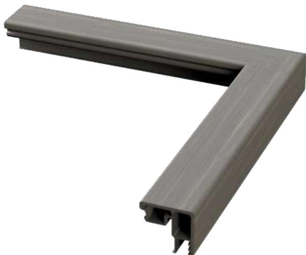
9) Nel Caso si voglia realizzare una chiusura ad angolo, tagliare circa 50 cm di step-profile e avvitare una piastra ad L inserendola nell'apposita scanalatura posteriore.
