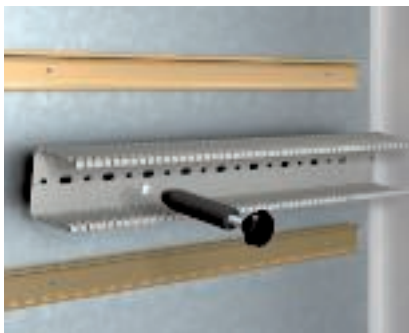
Montaggio canale di cablaggio Il canale di cablaggio VK viene fissato alla piastra di montaggio del quadro elettrico per mezzo di rivetti. I rivetti ad espansione sono inseriti mediante l'utensile per chiodatura in plastica.
