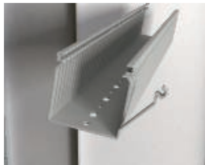
Separazione delle linguette Piegarle le linguette verso l'esterno. Se si supera l'angolo di curvatura di circa 70° - 80°, le linguette si spezzano.
